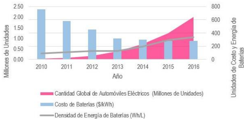
Gráfico 3. Evolución en costos y densidad de energía en baterías, versus el crecimiento del mercado de automóviles eléctricos (BID, 2018)
